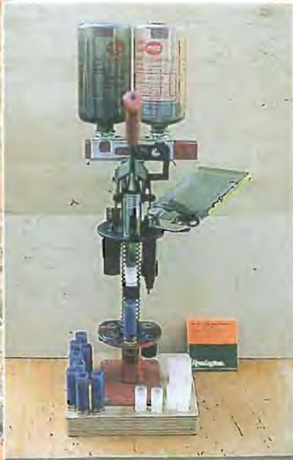
Mit dieser manuellen Wiederladepresse kann man etwa 150 bis 200 Schrotpatronen pro Stunde laden FOTO: P. KELLER
